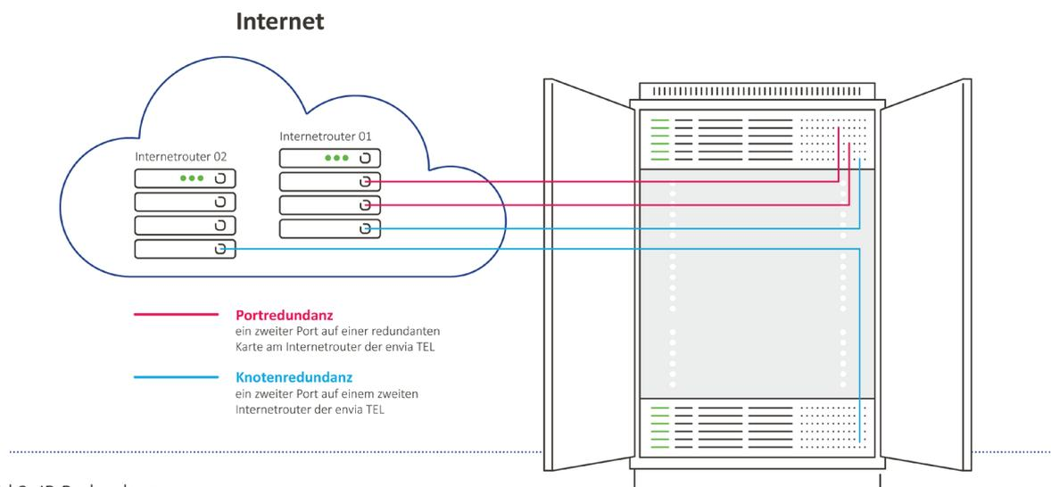
Bild 2: IP-Redundanz
